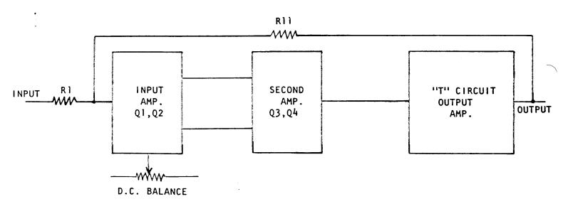
Figure 3-2 POWER AMPLIFIER BLOCK DIAGRAM
